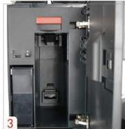
Шаг 3: Промойте устройство чистой холодной водой и установите на фиксатор, переведите фиксатор в верхнее положение, до фиксации устройства. Затем установите контейнер для отходов.
