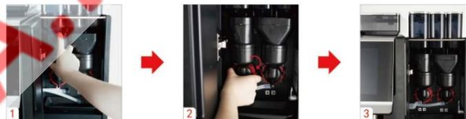
Шаг 4: Установите воронки миксеров на место и поверните фиксаторы по часовой стрелке, затем подключите трубки подачи напитков, короткую трубку к левому миксеру и длинную к правому.
